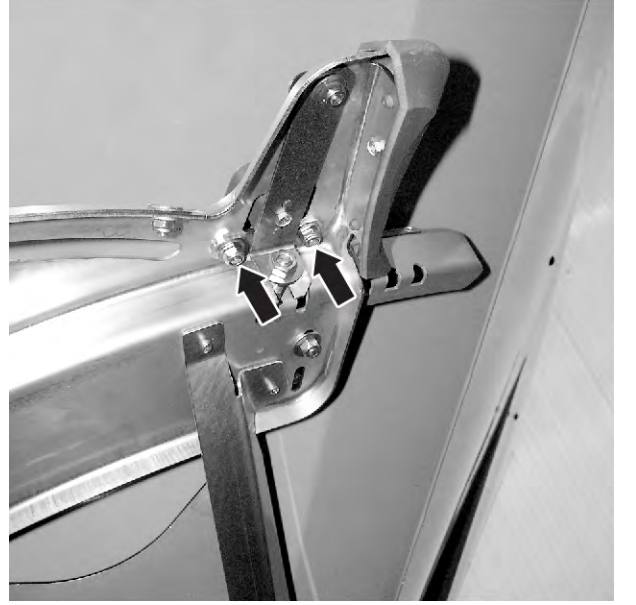
Şek. 70: Gübre verme noktası düzeltme levhasının sökülmesi
