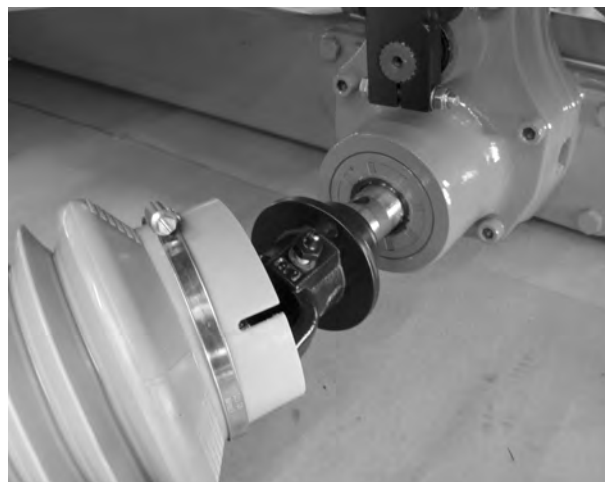
Sl. 12: Kardansko gred priključite na priključno gred.
