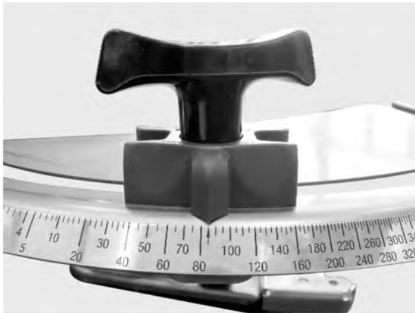
Obr. 66: Stupnica na nastavenie dávkovacieho posúvača
