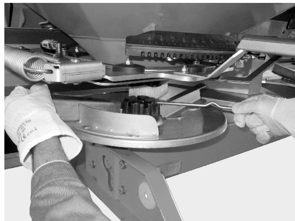
Sl. 47: Otpuštanje slepe navrtke
