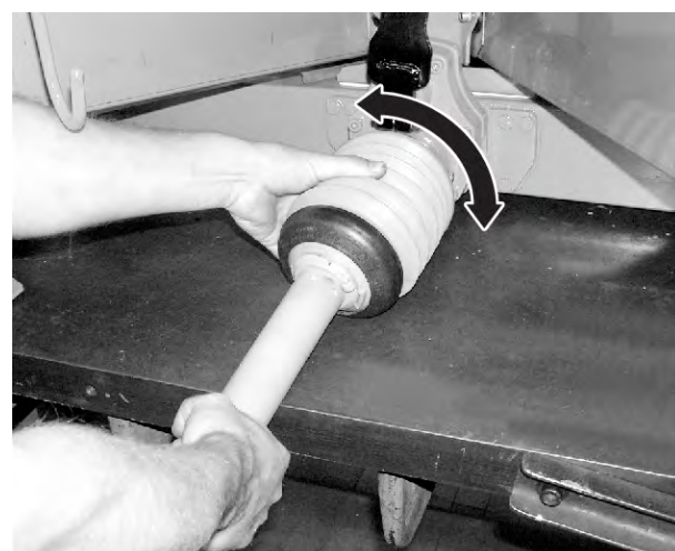
Рис. 15: Прикладывание защитного кожуха карданного вала
