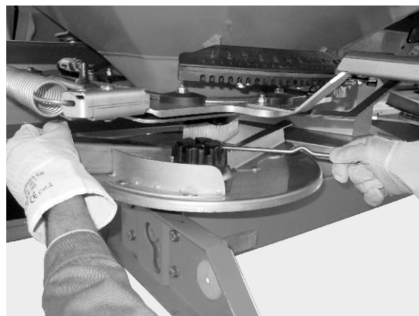
Рис. 37: Отвинчивание колпачковой гайки
