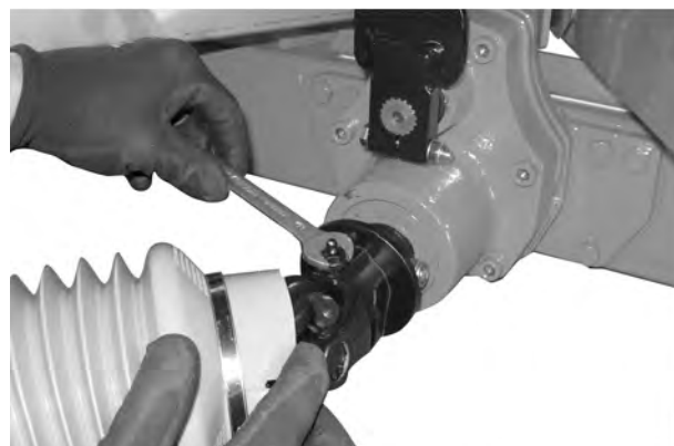
Fig. 14: Fastspænding af smørenippel
