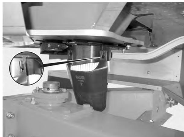
*Ilust. 48: Enganchar el plano inclinado de prueba de giro*
