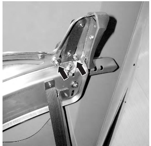
*Ilust. 70: Soltar la chapa de ajuste del punto de salida*
