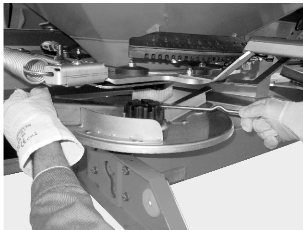
Fig. 37: Slăbiți piulița cu pălărie
