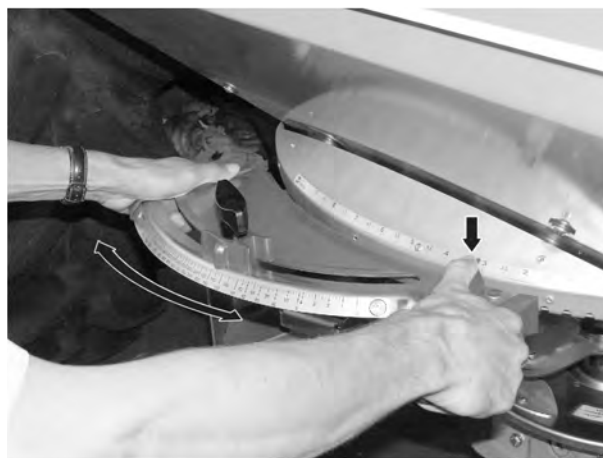
Fig. 39: Centru de reglare punct de alimentare
