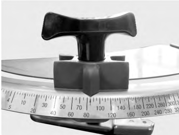
Σχ. 66: Κλίμακα ρύθμισης συρόμενου δοσομετρητή
