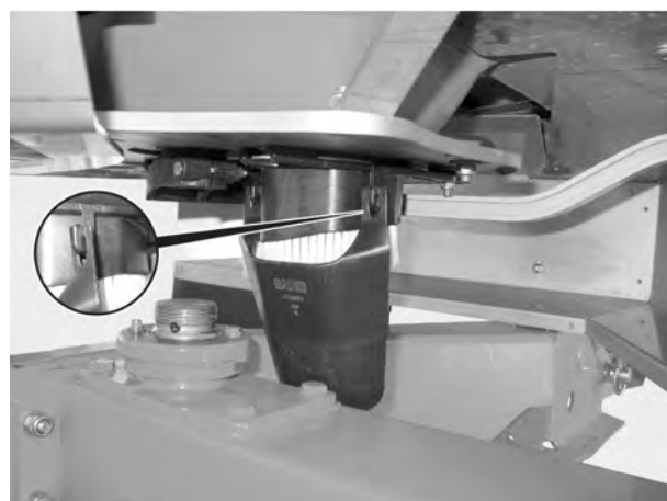
Rys. 48: Zawieszanie zsuwni do próby rozsiewu
