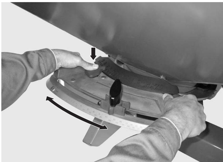
**Imagen 8.5:** Centro de ajuste punto de salida
