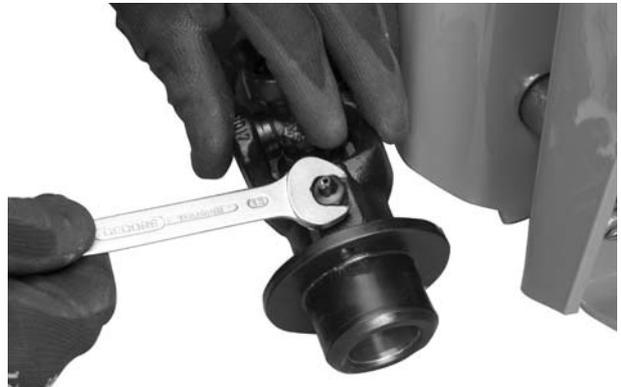
**Imagen 7.2:** Soltar boquilla de lubricación
