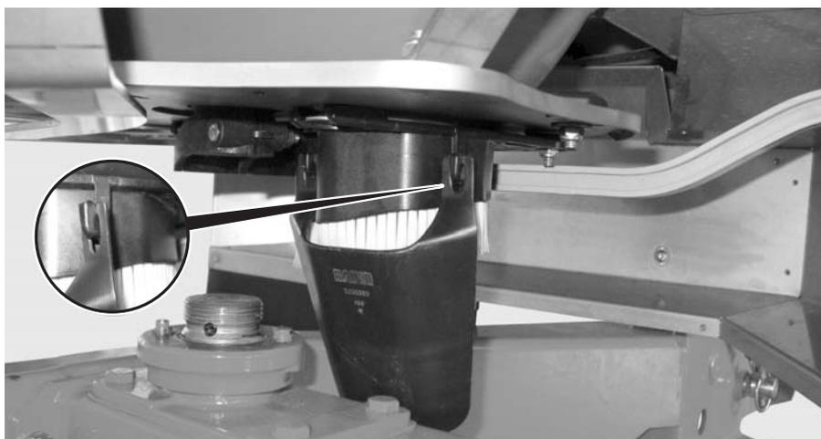
Imagen 8.13: Enganchar el plano inclinado de prueba de giro
