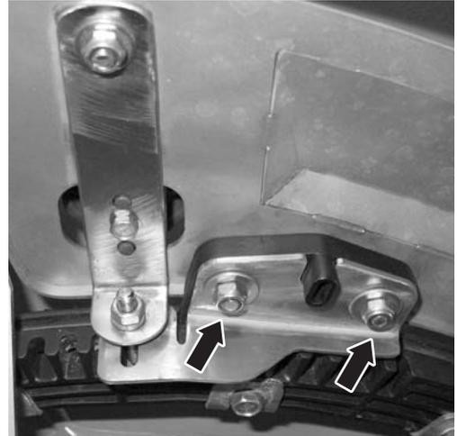
**Imagen 10.17:** Soltar la chapa de ajuste del punto de salida
