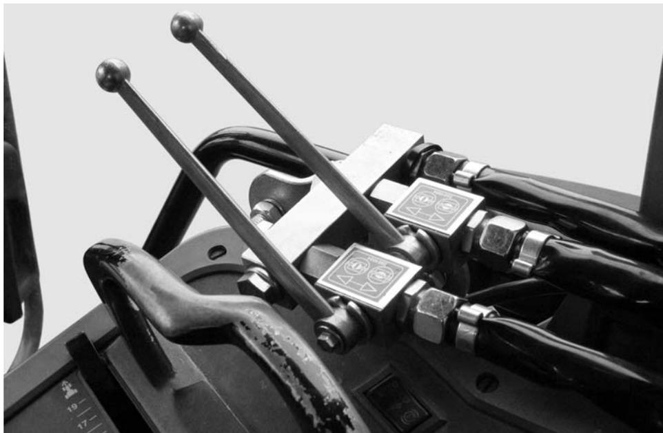
**Imagen 7.12:** Accionamiento de correderas de la unidad de dos vías
