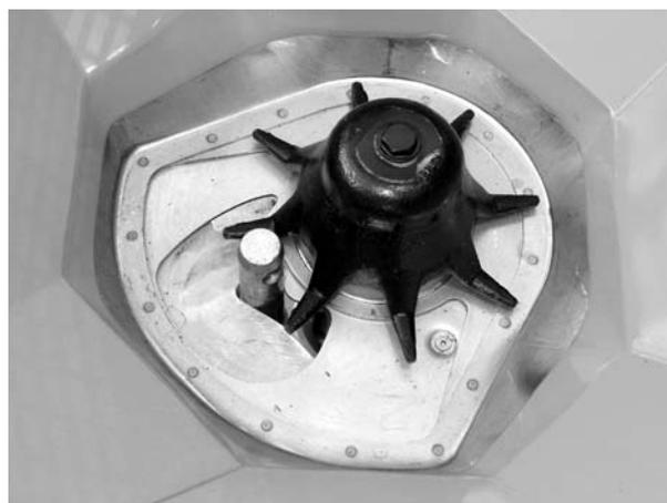
1. Introducir un perno de brazo inferior de **28 mm** de manera centrada en el orificio de dosificación.
