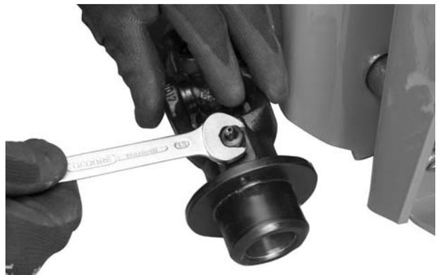
**Figura 7.2:** Svitare il raccordo per lubrificazione
