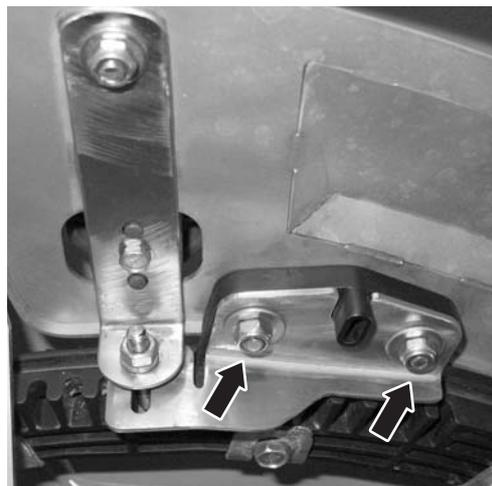
**Figura 10.17:** Staccare il pannello di taratura del punto di applicazione
