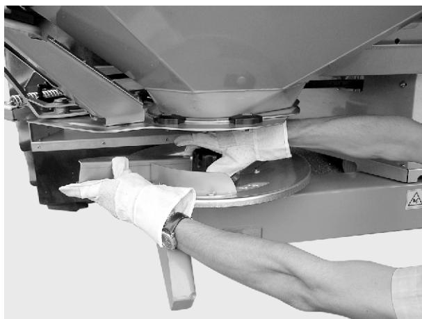
Sl. 39: Pričvršćivanje slepe navrtke
