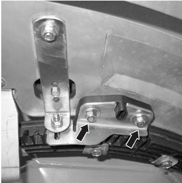
Рис. 62: Ослаблення юстувальної пластини точки подачі
