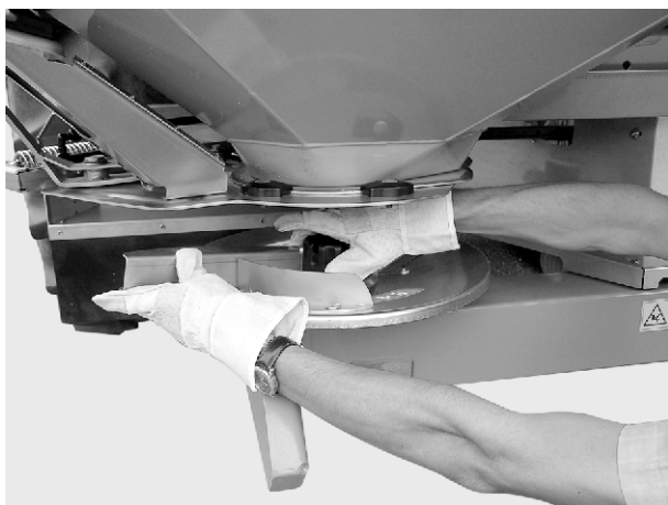
Рис. 39: Закручування ковпачкової гайки
