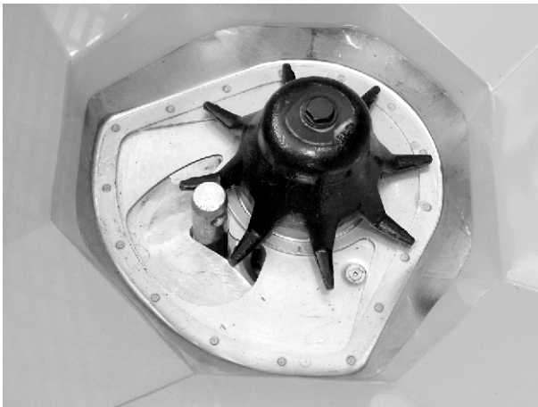
Рис. 58: Болт нижньої тяги в дозувальному отворі
