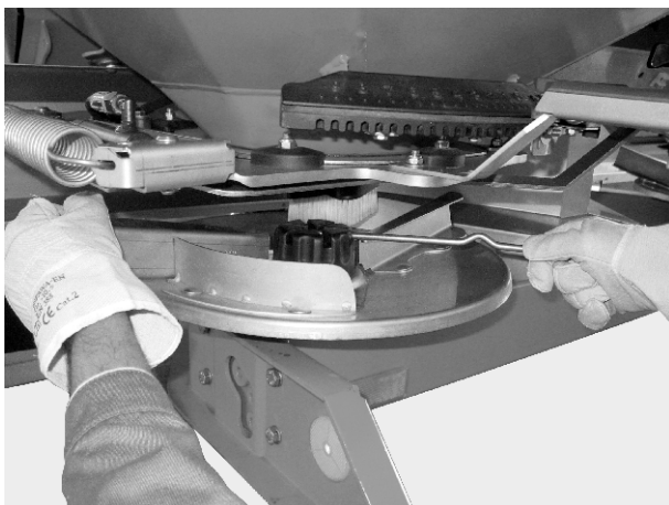
Рис. 36: Ослаблення ковпачкової гайки
