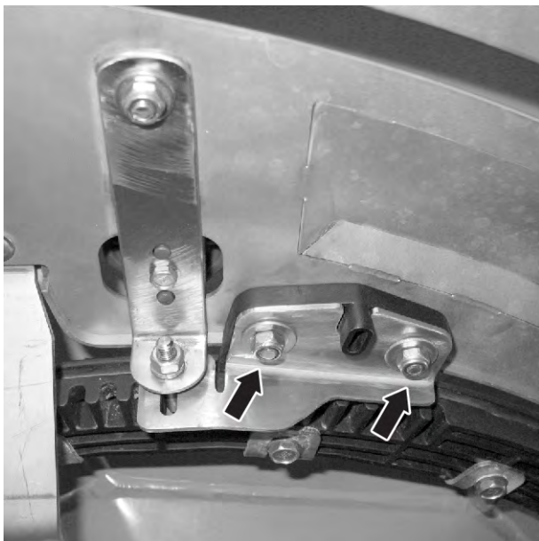
Рис. 62: Ослаблення юстувальної пластини точки подачі
