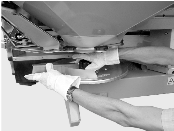
Рис. 39: Закручування ковпачкової гайки
