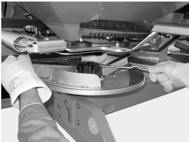
Рис. 36: Ослаблення ковпачкової гайки
