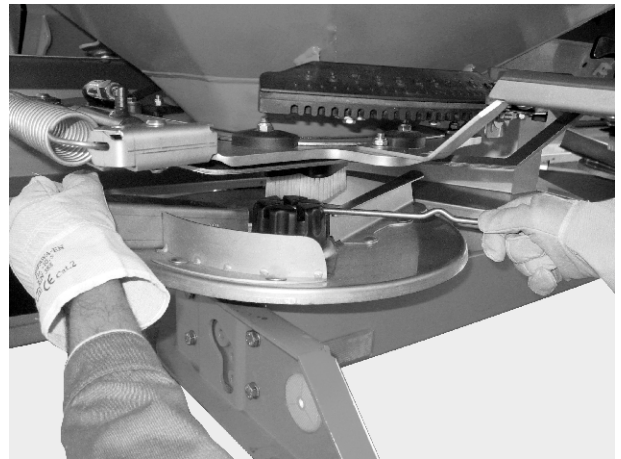
Σχ. 27: Χαλάρωση τυφλού παξιμαδιού
