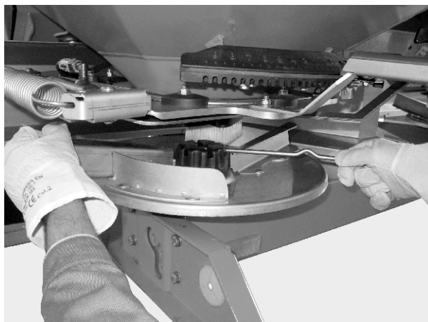
Σχ. 36: Χαλάρωση τυφλού παξιμαδιού
