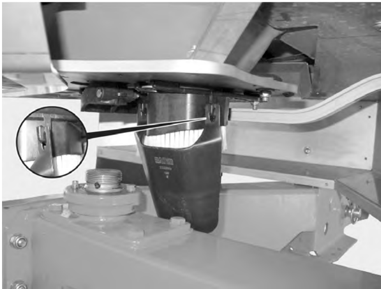
Σχ. 37: Ανάρτηση ολισθητήρα δοκιμής βαθμονόμησης
