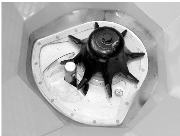
Σχ. 58: Μπουλόνι κάτω συνδέσμου μέσα στο δοσομετρικό άνοιγμα
