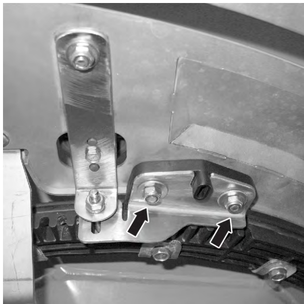
Sl. 62: Sprostitev nastavitvene pločevine točke dovajanja
