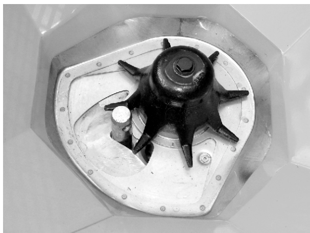
Sl. 58: Zatič spodnjega vodila v dozirni odprtini
