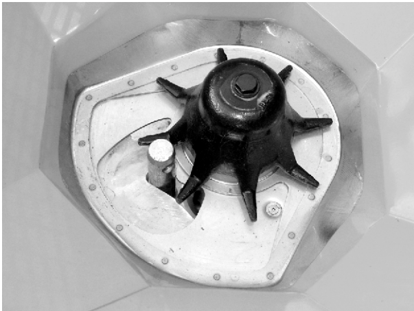
Sl. 58: Zatič spodnjega vodila v dozirni odprtini
