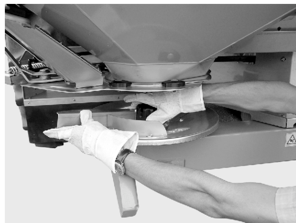
Sl. 28: Odvijanje klobučaste matice
