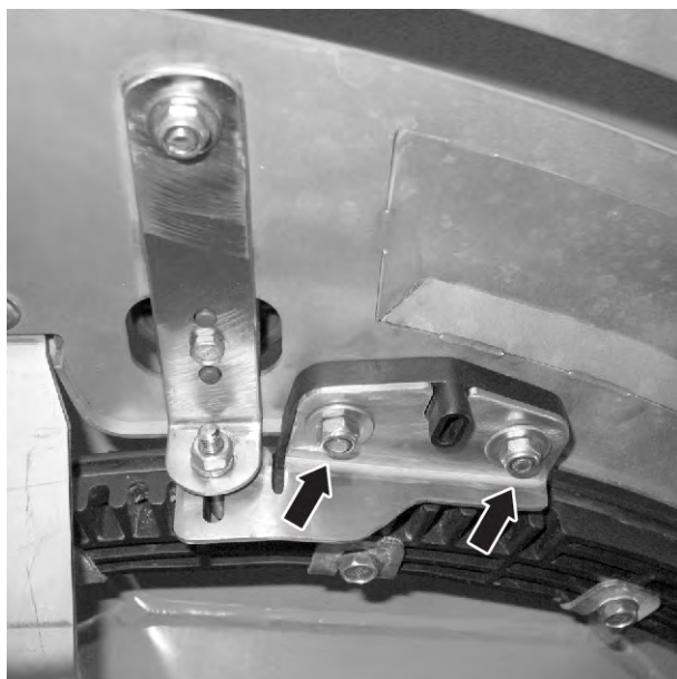
Jn. 62: Äraandmispunkti reguleerimisplaadi avamine
