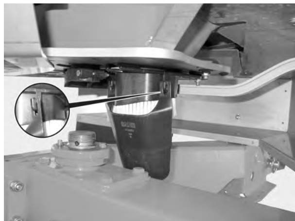
Att. 37: Dozēšanas izmēģinājuma renes iekāršana
