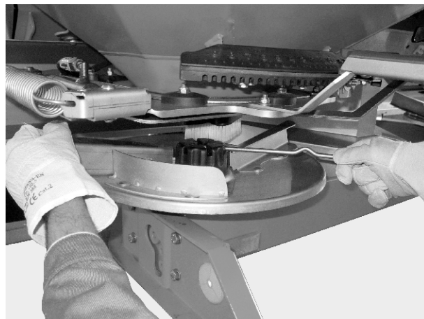
Att. 36: Kupoluzgriežņa atskrūvēšana
