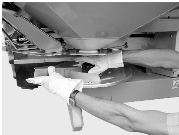
Att. 28: Kupoluzgriežņa noskrūvēšana
