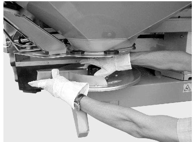
Att. 28: Kupoluzgriežņa noskrūvēšana
