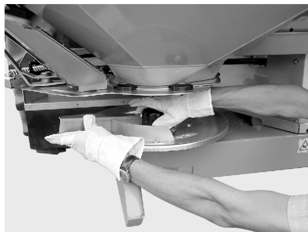
Att. 28: Kupoluzgriežņa noskrūvēšana
