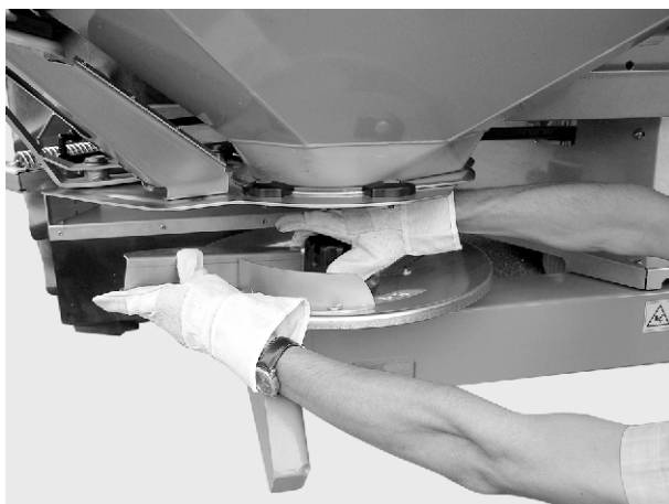
Att. 39: Kupoluzgriezņa pieskrūvēšana
