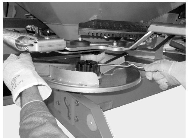
Pav. 27: Gaubiamosios veržlės atlaisvinimas
