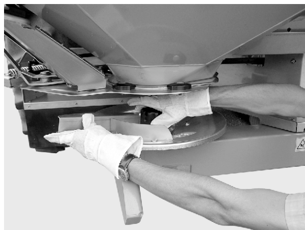
Pav. 39: Gaubiamosios veržlės priveržimas
