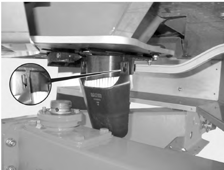
Pav. 37: Trąšų įterpimo kiekio nustatymo lataką pakabinimas
