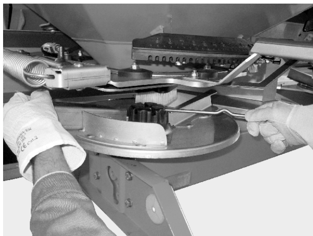
Pav. 36: Gaubiamosios veržlės atlaisvinimas
