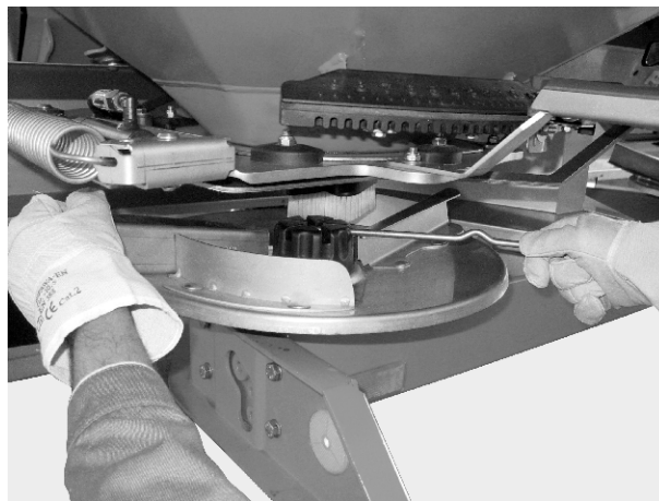
Pav. 27: Gaubiamosios veržlės atlaisvinimas
