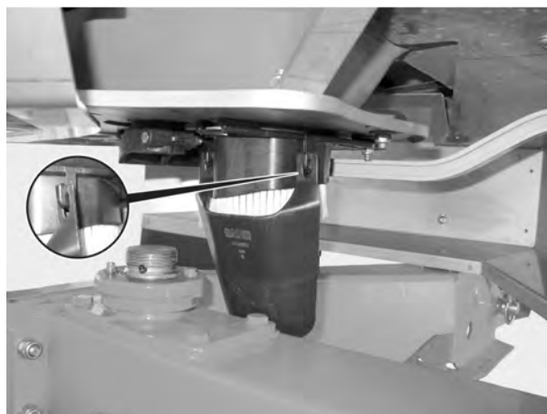
Obr. 37: Zavesenie sklzného žľabu na skúšobné rozmetávanie
