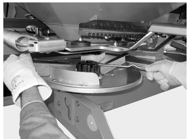
Obr. 36: Uvoľnenie uzavretej matice
