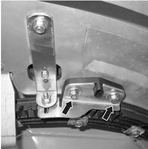
Obr. 62: Uvoľnenie nastavovacieho plechu bodu dávkovania
