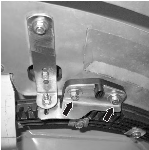
Obr. 62: Uvoľnenie nastavovacieho plechu bodu dávkovania
