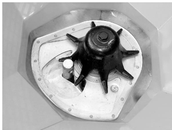
Фиг. 58: Болт на долния свързващ прът в дозирация отвор
