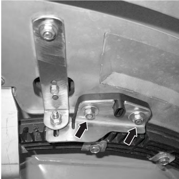
Фиг. 62: Освобождаване на регулиращата пластинка за точката на подаване
