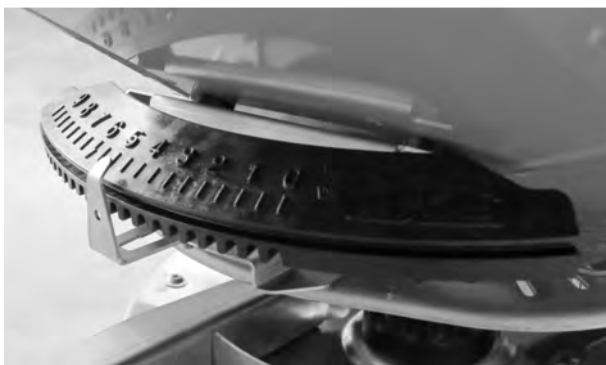
Фиг. 29: Индикатор за точката на подаване (пример)
