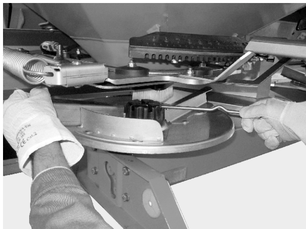
Фиг. 36: Развиване на глухата гайка
