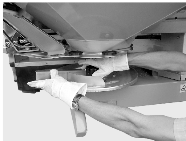
Фиг. 28: Развиване на глухата гайка
