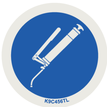
Фиг. 63: Указателна табелка за точка на смазване
