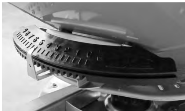
Фиг. 29: Индикатор за точката на подаване (пример)
