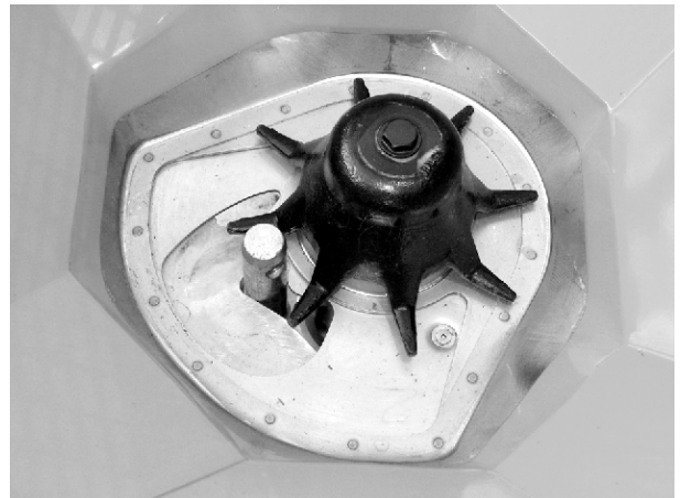
Fig. 58: Trekkstangbolt i doseringsåpning
