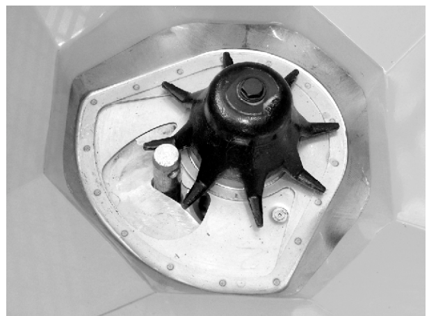
Ilust. 58: Perno de la barra de tiro en el orificio de dosificación
