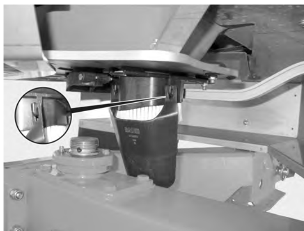
Ilust. 37: Enganchar el plano inclinado de prueba de giro
