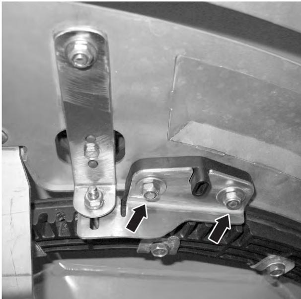
*Ilust. 62: Soltar la chapa de ajuste del punto de aplicación*
