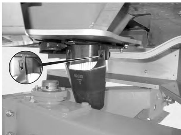
*Ilust. 37: Enganchar el plano inclinado de prueba de giro*
