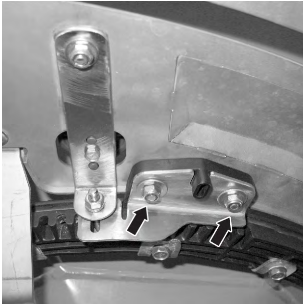
Kuva 62: Luovutuspuisten säätöpellin irrotus
