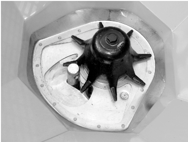
Fig. 58: Dragstångsbult i doseringsöppning
