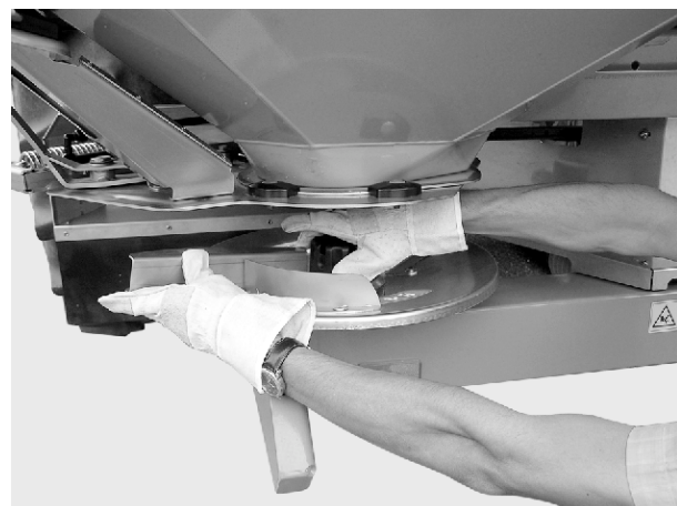
Рис. 28: Откручивание колпачковой гайки
