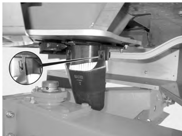
Рис. 37: Навешивание лотка для установки нормы внесения
