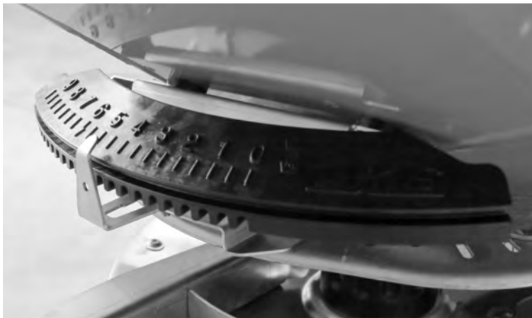
Fig. 29: Afișare pentru punctul de alimentare (exemplu)
