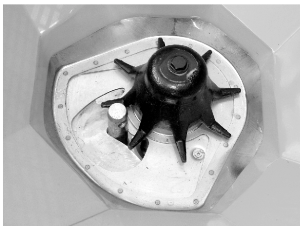
Fig. 58: Bolțul de la bara de cuplare inferioară în deschiderea de dozare
