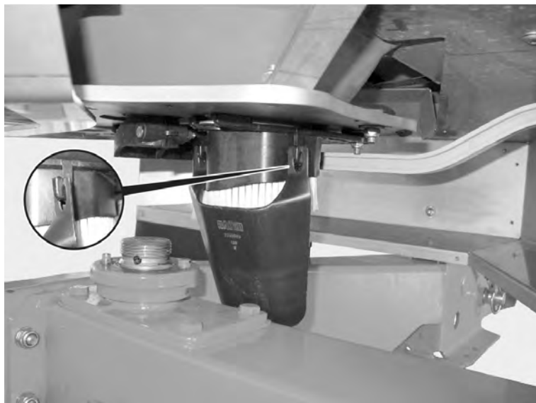
Fig. 37: Agățarea jgheabului pentru proba de calibrare
