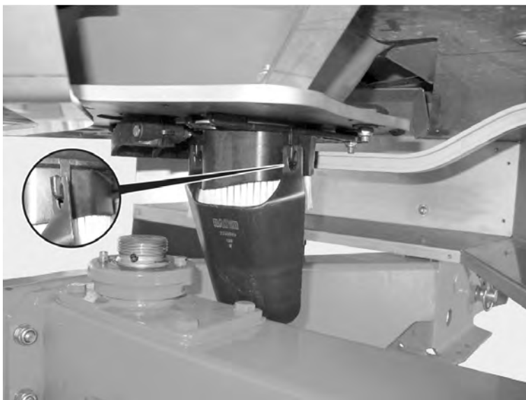
Rys. 37: Zawieszanie zsuwni do próby rozsiewu
