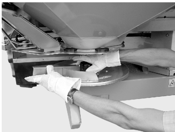
Rys. 39: Przykręcanie nakrętki kołpakowej
