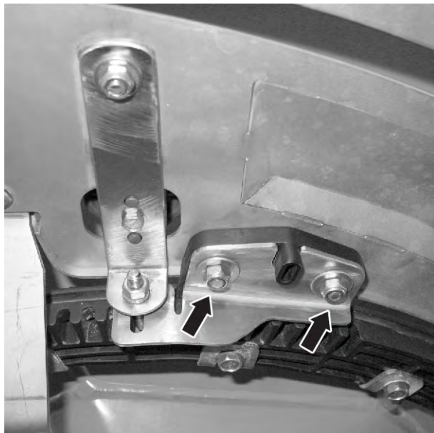
Rys. 62: Odkręcanie blachy regulacyjnej punktu dozowania
