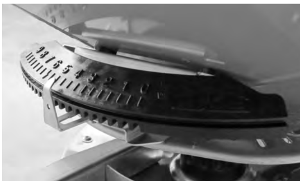
Rys. 29: Wskaźnik punktu podawania (przykład)
