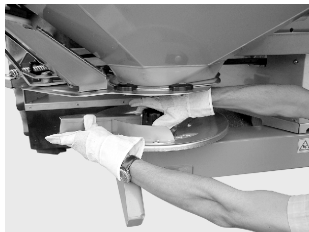
Rys. 28: Odkręcanie nakrętki kołpakowej
