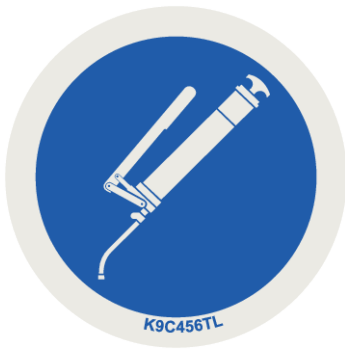
Rys. 63: Tabliczka informacyjna: punkt smarowania
