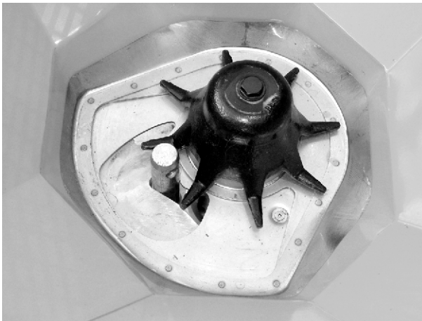
Rys. 58: Trzpień dolnego ramienia podnośnika w otworze dozującym
