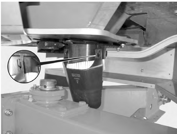
Rys. 37: Zawieszanie zsuwni do próby rozsiewu
