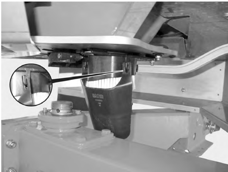
Afb. 37: Glijgoot voor de afdraairoef ophangen
