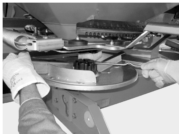
Fig. 36: Løsning af kalotmøtrikken
