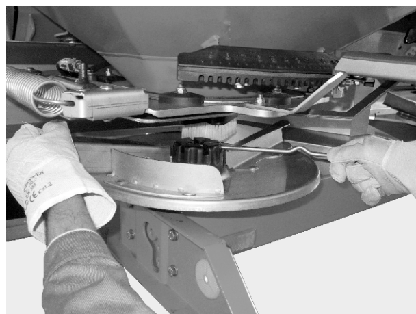
Fig. 27: Løsning af kalotmøtrikken
