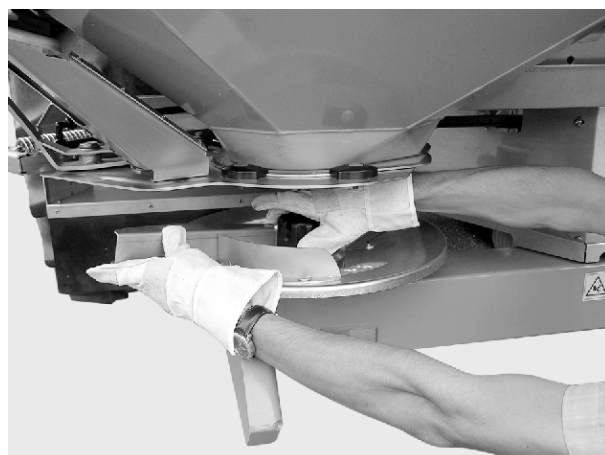
Fig. 39: Stramning af kalotmøtrikken
