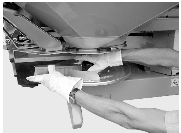
Fig. 28: Udskruning af kalotmøtrikken
