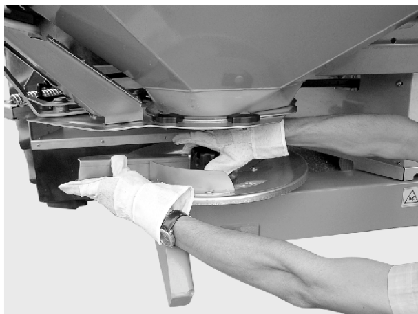
Fig. 39: Iskruning af kalotmøtrikken
