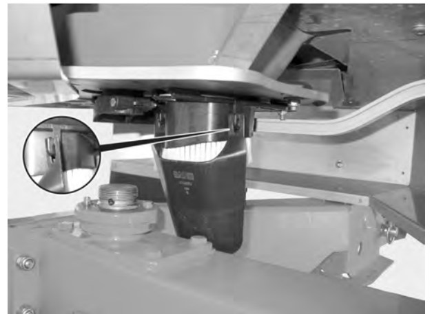
III. 37: Agganciamento dello scivolo per il test di taratura
