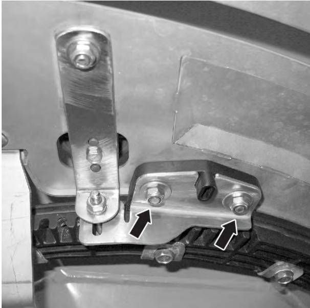
Ill. 62: Staccare il pannello di taratura del punto di applicazione
