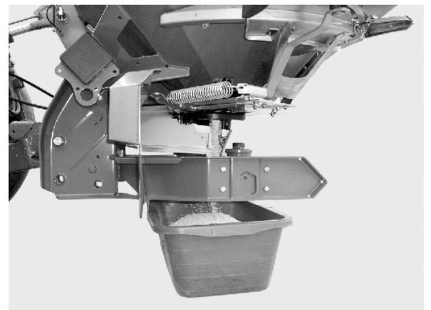
*Ill. 38: Esecuzione del test di taratura*
