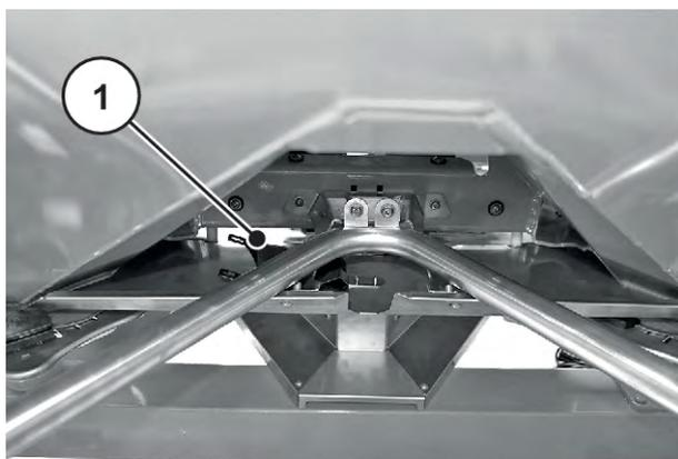
III. 35: Scivolo per il test di taratura
