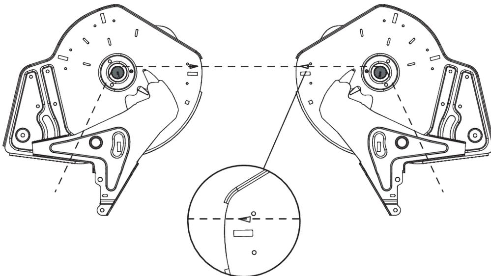
III. 61: Controllo della regolazione del punto di applicazione
