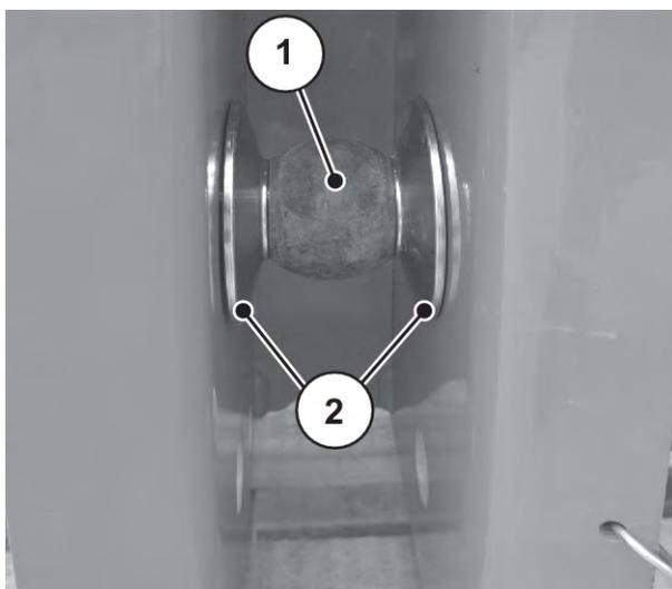
*Ill. 11: Posizionamento dei distanziatori nel montaggio della macchina*
