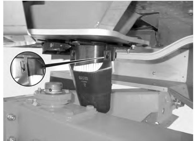
*Ill. 37: Agganciamento dello scivolo per il test di taratura*
