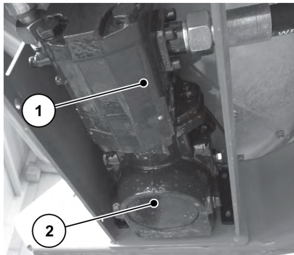
III. 65: Motore idraulico
