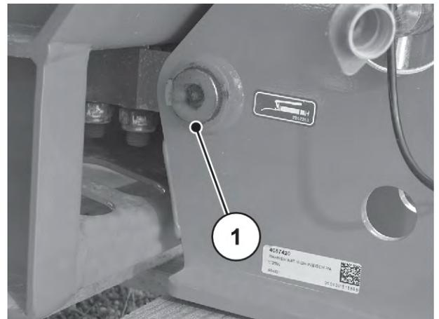
III. 64: Punto di lubrificazione dello spandiconcime con sistema di pesatura
