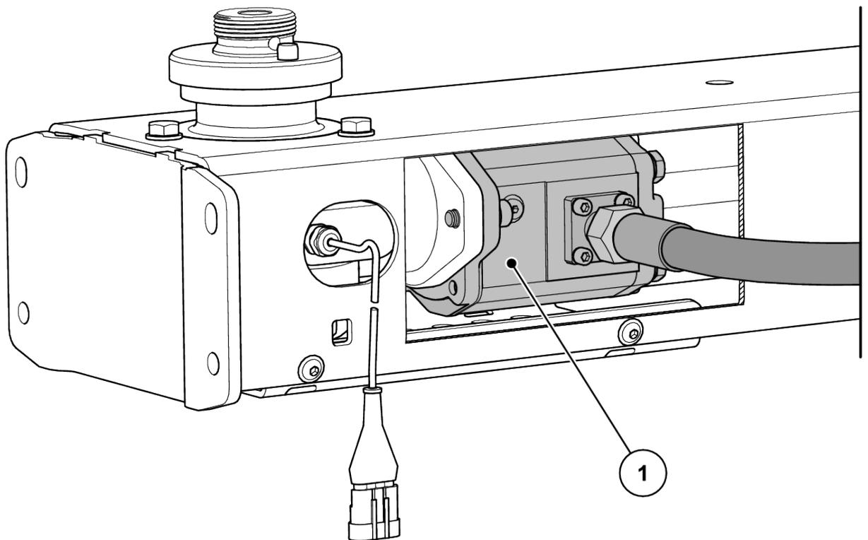
III. 8: Motore idraulico per il comando dischi di lancio
