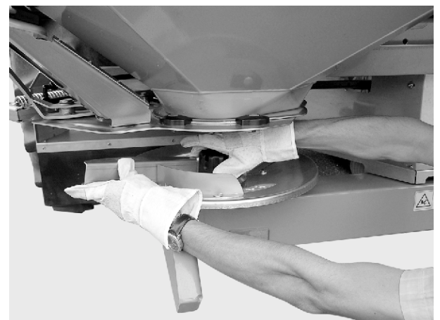
III. 28: Svitamento del dado a cappello
