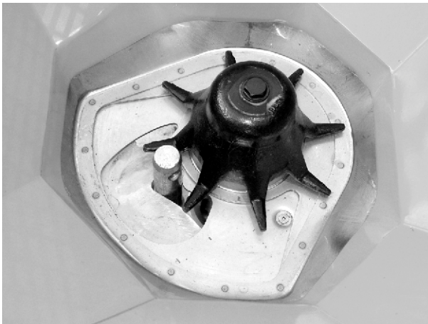
III. 58: Perno del braccio inferiore nell'apertura di dosaggio
